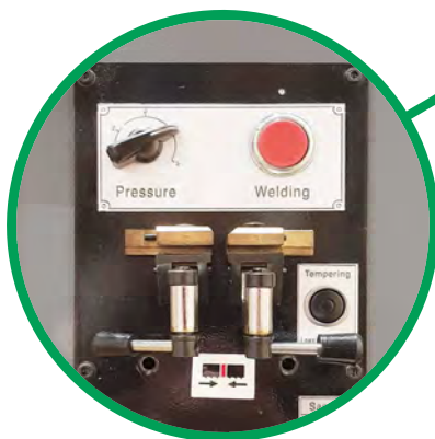
Knip-, las- en slijpinrichting t.b.v. lintzaagblad
